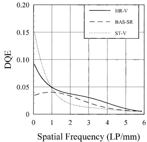
Fig. 6 DQE of each IP at exposure of  $3.3\mu\text{C}/\text{kg}$
